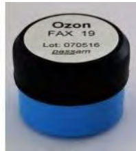
Figure 27 : Echantillonneur passif Passam pour O 3
