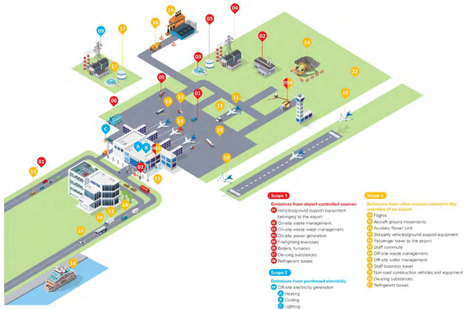
Figure 11 : Sources émettrices de GES à l'échelle d'une plateforme aéroportuaire (source image : Airport Carbon Accreditation)
