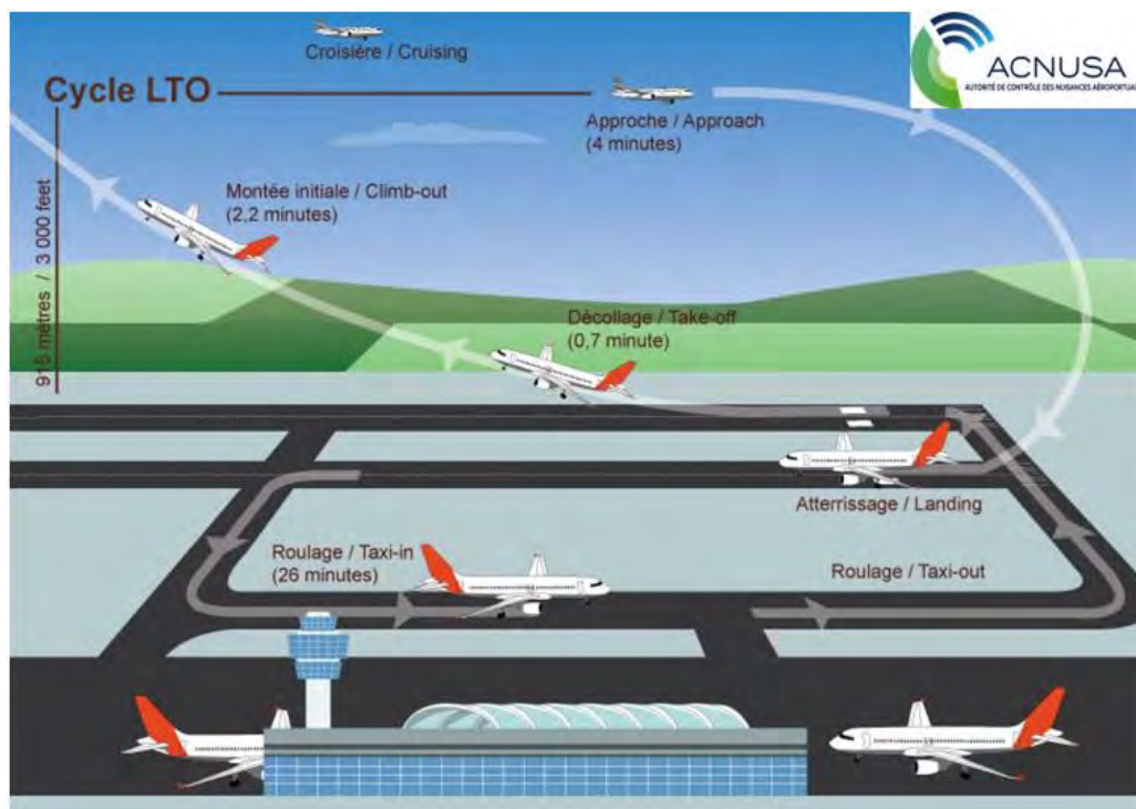
Figure 4: Schématisation du cycle LTO, source : ACNUSA
