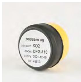
Figure 28 : Echantillonneur passif Passam pour SO 2
